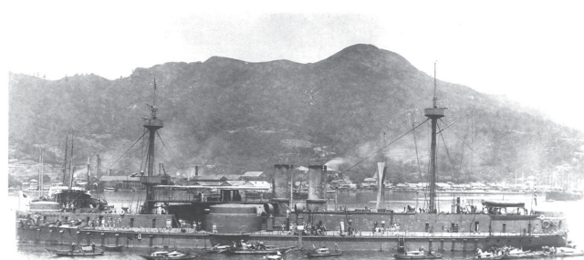
Zhenyuan, Schlachtschiff aus Stahl, 1882, Vulkan, Stettin, 7430 Tonnen, 14,5 Knoten, vier 12-Zoll-Geschütze, zwei 5,9-Zoll-Geschütze, drei 14-Zoll-Torpedorohre. Text u. Abb.: 9
