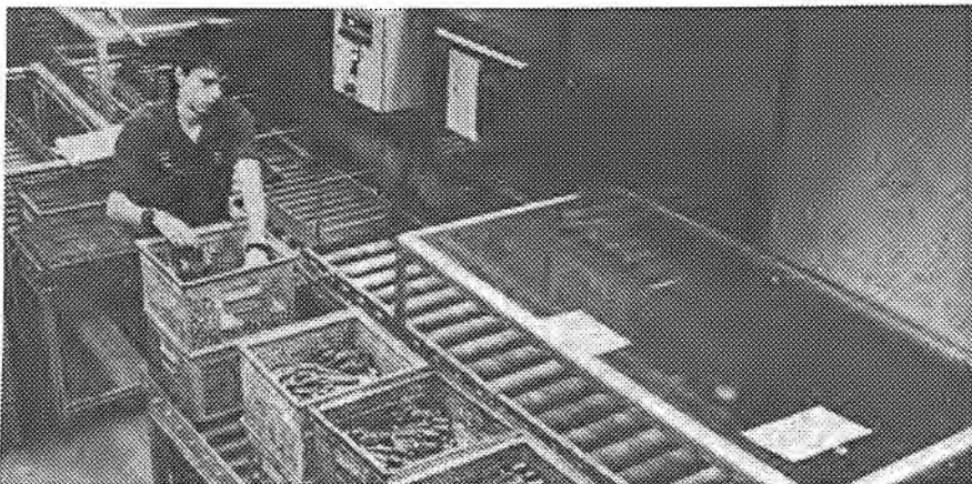
Das Bild zeigt eine neue Auswaschanlage, die mit entsalztem Wasser arbeitet. Die meisten Anlagen arbeiten noch mit dem giftigen Trichloräthylen.
