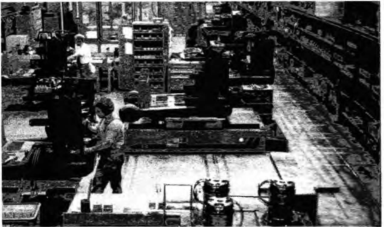
Blick in die Montage der Schubmaststapler: Induktiv geführte Flurförderzeuge bringen die Fahrzeugrahmen automatisch an den Montageplatz.
