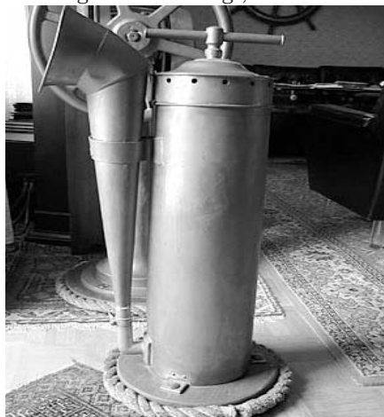
Nebelhorn, England um 1920, für den Handbetrieb. – Bei unklaren Sichtverhältnissen empfiehlt sich, laut zu tuten. maf
